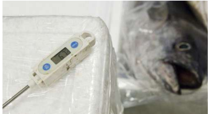
Le thermomètre à sonde permet de mesurer la température à cœur du produit, ici non-conforme : la température du poisson ne doit pas dépasser + 2 °C.
